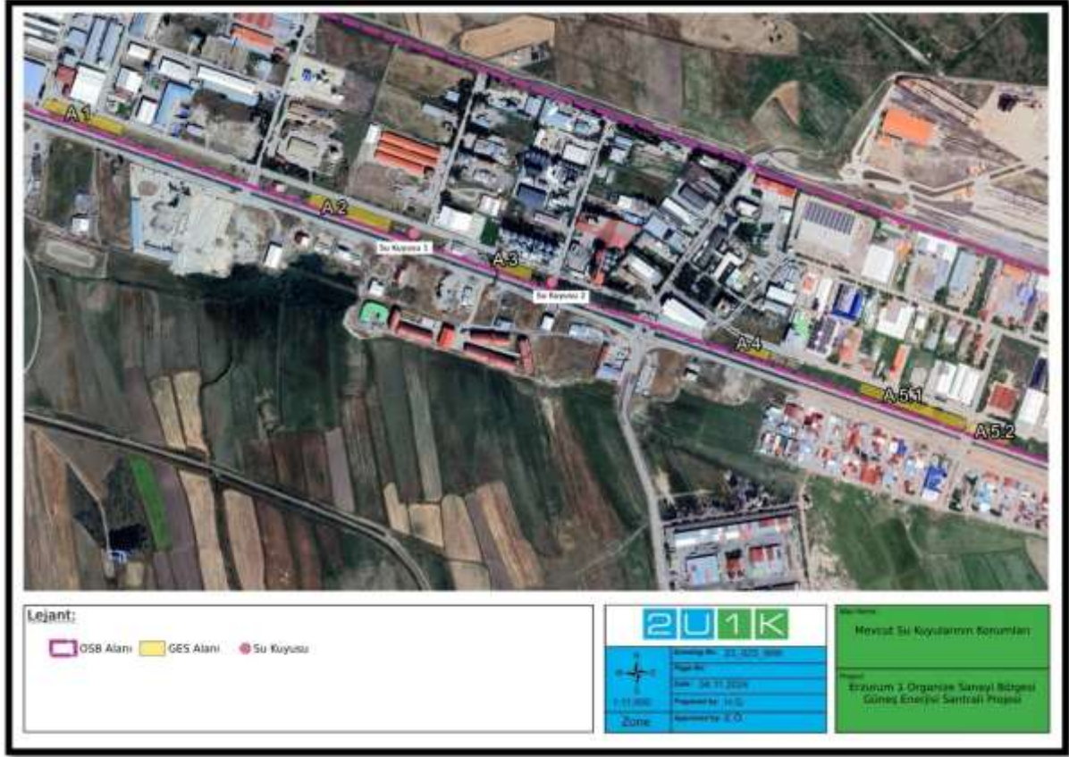
Şekil 5-7. Mevcut Yeraltı Suyu Kuyularının Konumu
